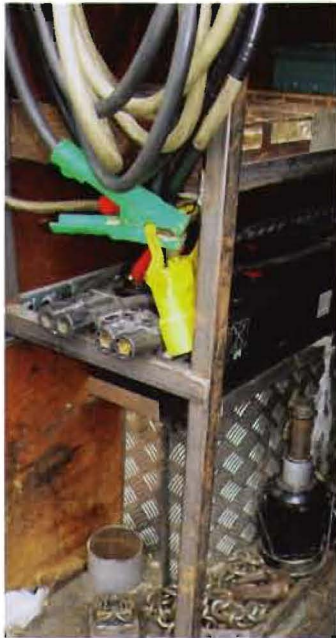
Fabrication maison : le dispositif de batteries auxiliaires avec prises rapides pour les remises en route en 24V
